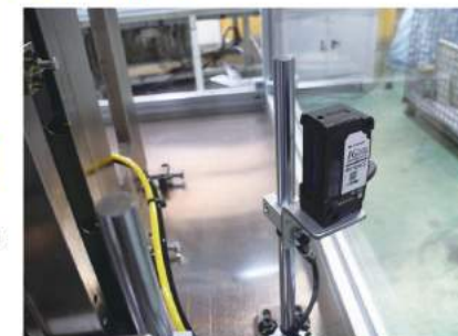
雷射感測器 Laser sensor
